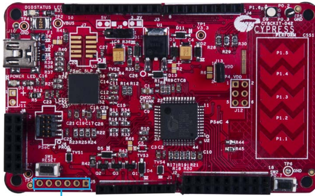
Digilent® Pmod™ Compatible I/O Header (J5)
